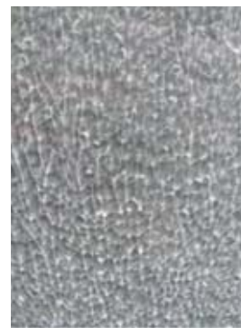
Образец стекла с «правильной закалкой»
