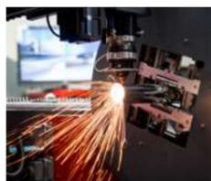
Полотенцесушители POINT сварены методом лазерной сварки. Высокая скорость и точность сварки позволяет не изменять химические и физические свойства металла. Избегая обширного критичного перегрева металла, сварные швы впоследствии не поддаются коррозии в контакте с активным кислородом. Лазерной сваркой обеспечивается **надежность и эстетика** сварного шва.
