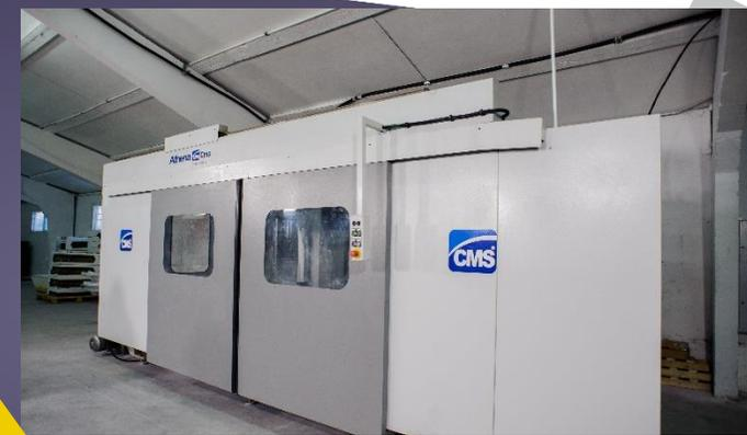
ДЛЯ МЕХАНИЧЕСКОЙ ОБРАБОТКИ И ФРЕЗЕРОВАНИЯ СЛИВНЫХ ОТВЕРСТИЙ ИСПОЛЬЗУЕТСЯ **ПЯТИКООРДИНАТНЫЙ ФРЕЗЕРНЫЙ КОМПЛЕКС С ЧПУ CMS АТЕНА ПРОИЗВОДСТВА ИТАЛИЯ**
