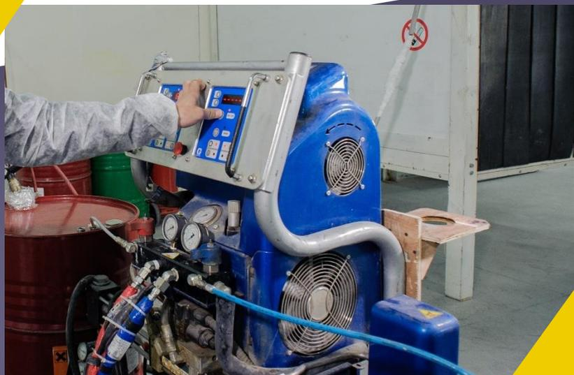
АРМИРОВКА АКРИЛОВОЙ ФОРМЫ ОСУЩЕСТВЛЯЕТСЯ ПРИ ПОМОЩИ ИТАЛЬЯНСКОЙ МНОГОКОМПОНЕНТНОЙ ДОЗИРУЮЩЕЙ СИСТЕМЫ GRACO REACTOR, ЧТО ОБЕСПЕЧИВАЕТ РАВНОМЕРНОЕ НАНЕСЕНИЕ АРМИРУЮЩЕГО ПОКРЫТИЯ НА ПОВЕРХНОСТЬ АКРИЛОВОЙ ФОРМЫ
