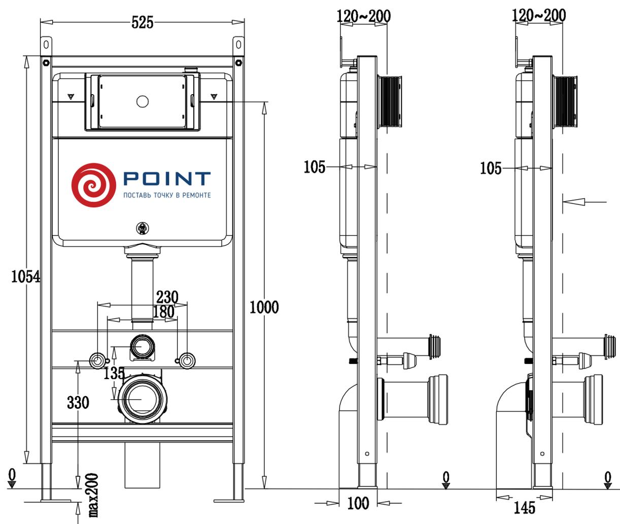
Фановый отвод для слива, диаметр отводной трубы 90 мм, регулируемый по глубине. При выпуске прямо в пол общая толщина изделия 100 мм., требуемый отступ финишной поверхности от стены 120 мм, при горизонтальном или косом выпуске общая толщина изделия 145 мм, требуемый отступ финишной поверхности от стены 166 мм.
