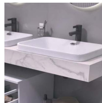
Столешницы изготовлены из фанеры с HPL пластиком
